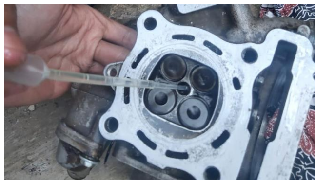
Gambar 3. 5 Pengukuran Volume lubang injector (0,75 ml)
