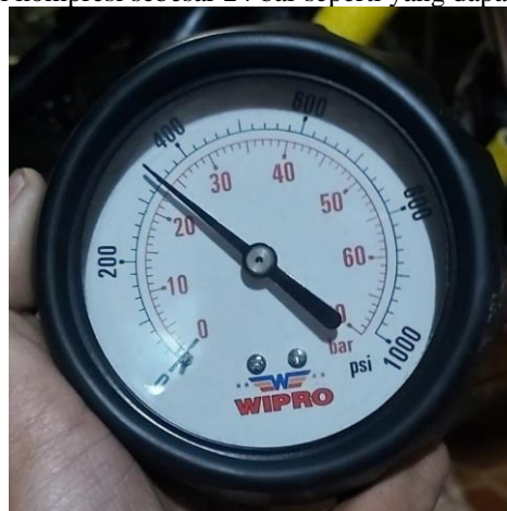
Gambar 3. 6 Kompresi Ruang Bakar
