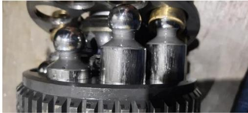
Gambar 3 8 Terdapat goresan pada Piston motor
