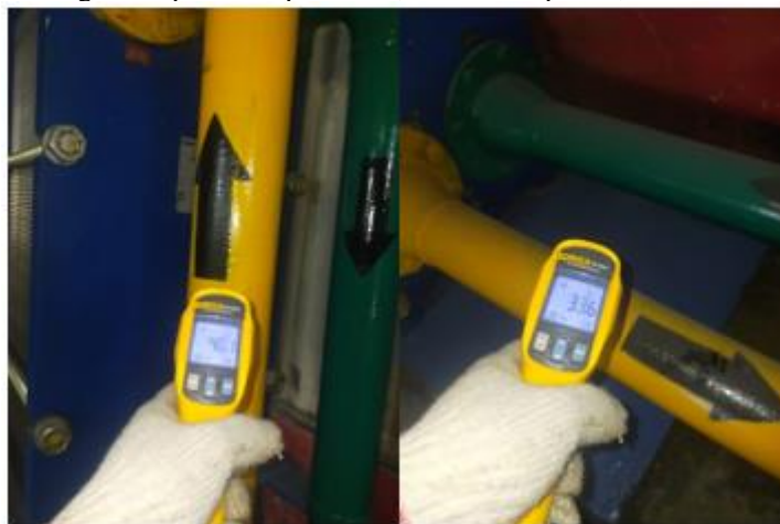
Gambar 7 Temperatur Sebelum dan Sesudah Heat Exchanger Hydac H172
