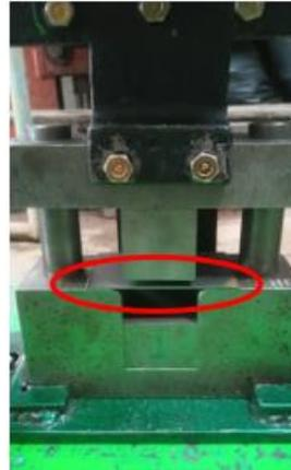
Gambar 2 Penempatan sampel uji pada alat bending
