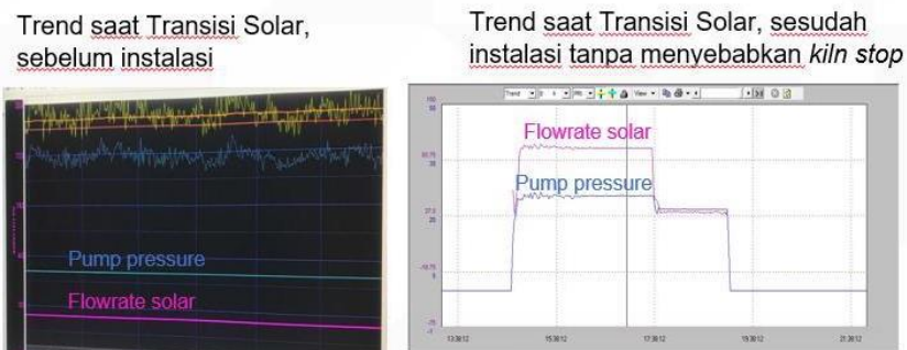
Gambar 6. Trend pressure dan flowrate dari penggunaan solar sebelum dan sesudah instalasi control valve baru
