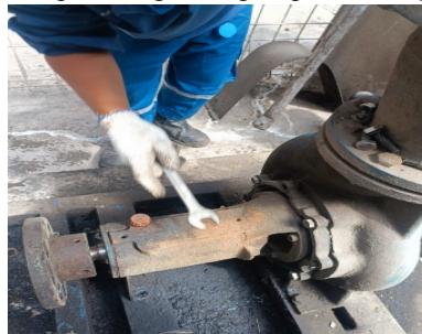
Gambar 3. 1 Terdapat tumpahan oli pada housing Bearing
