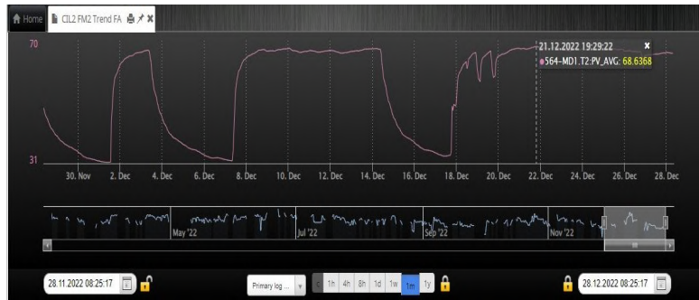
Gambar 7. Temperature Drive Bearing 2 Sebelum Modifikasi
