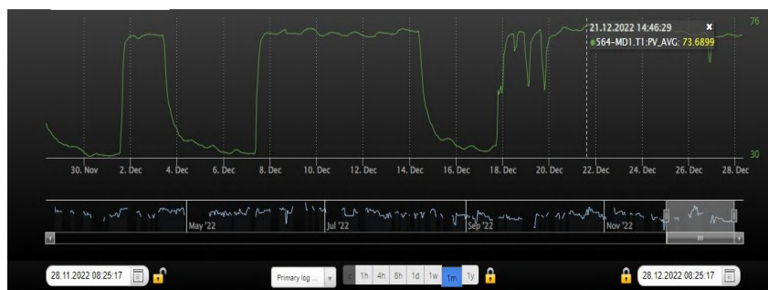
Gambar 5. Temperature Drive Bearing 1 Sebelum Modifikasi
