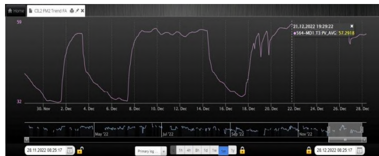
Gambar 9. Temperature Reducer Lube Oil Sebelum Modifikasi
