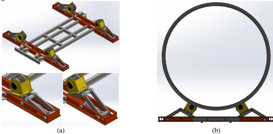
Gambar 5. Konsep rancangan troli diberikan pada gambar (a). Gambar (b) menunjukkan konsep rancangan troli ketika sedang mengangkat penstock
