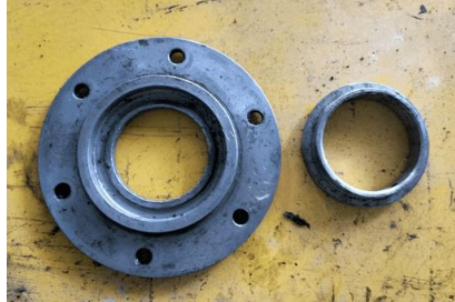
Gambar 5 flange bearing sebelum dimodifikasi
