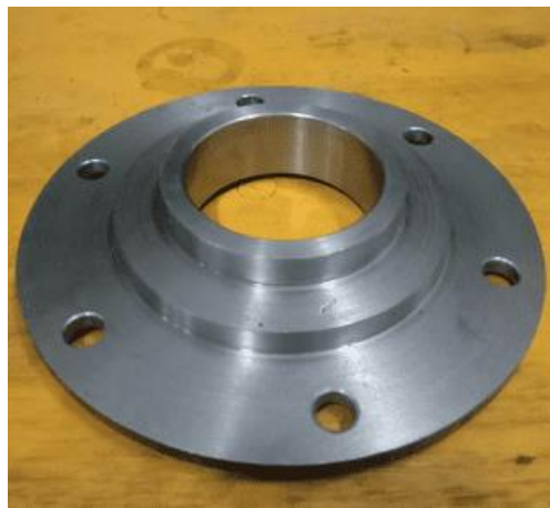
Gambar 6 Flange bearing setelah dimodifikasi
