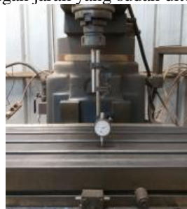
Gambar 13 Posisi dial saat pengujian kepararelalan meja kerja dengan gerakan membujur
