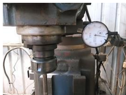
Gambar 11 Posisi dial saat pengujian simpang putar spindle utama
