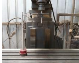
Gambar 17 Posisi dial pada pengujian ketegaklurusan gerak vertikal lutut
