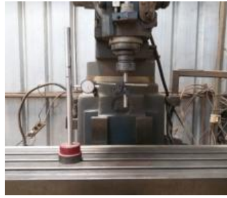
Gambar 15 Posisi dial saat pengujian ketegaklurusan gerak vertikal spindle
