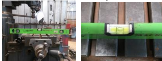
Gambar 10 Pengukuran level dalam arah melintang sesudah penyetaraan
