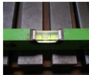
Gambar 7 Pengukuran level dalam arah melintang sebelum penyetaraan
