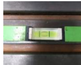
Gambar 6 Pengukuran level dalam arah membujur sebelum penyetaraan
