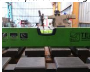
Gambar 7 Pengukuran level dalam arah melintang sebelum penyetaraan
