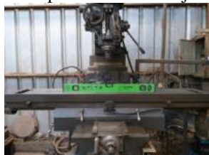
Gambar 6 Pengukuran level dalam arah membujur sebelum penyetaraan
