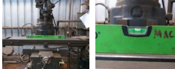
Gambar 9 Pengukuran level dalam arah membujur sesudah penyetaraan
