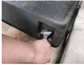
Gambar 8 Penyetingan level mesin
