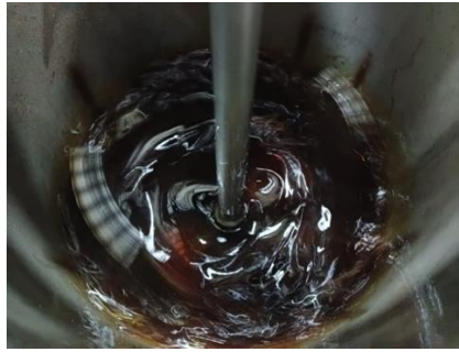
Gambar 2 Aliran yang dihasilkan oleh Agitator
