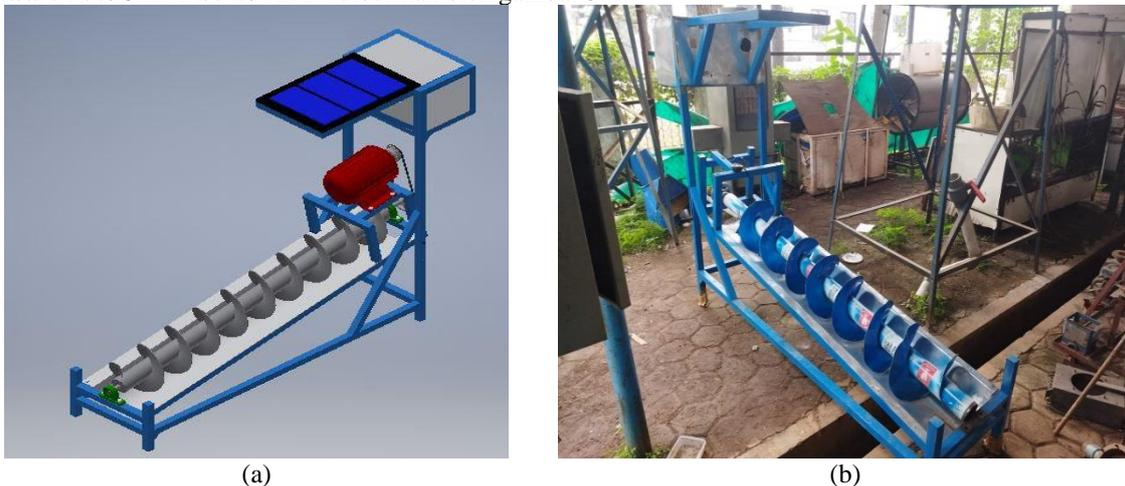
Gambar 3. Desain 3D PLTMH diberikan pada gambar (a). Gambar (b) menunjukkan realisasi alat.
