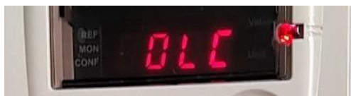
Gambar 4 Tampilan Display Saat Gangguan Overload
